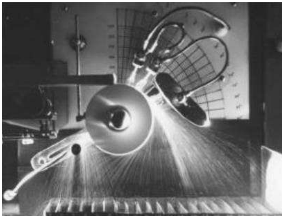
Figure I.18 : Trajectoire réel des particules dans un séparateur à cylindre tournant (laboratoire de séparation électrostatique Cluj-Napoca, Romania)
