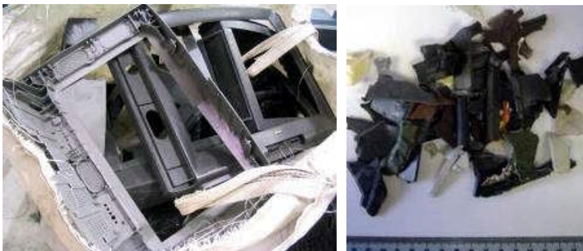
Figure I.8 : Résultat du broyage des carcasses de TV en plastique à l'aide d'un broyeur à cylindre denté modèle (Wagner 40) équipé d'un écran de 20 mm ; (a) : avant broyage ; (b) après broyage [32]
