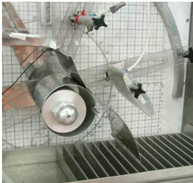
Figure I.19 : Séparateur à plaque en S (laboratoire de séparation électrostatique ; IUT d'Angoulême France) ;
