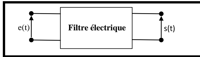
Figure I.3 : Signaux d'entrée et de sortie du filtre
