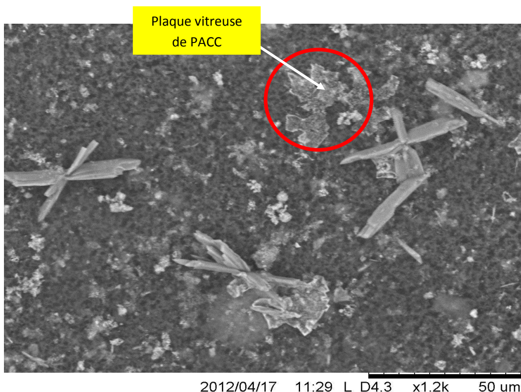
Figure V.76 Micrographie MEB de l'échantillon UQ 5 (en présence d'extrait de cerasus vulgaris à 1g/L) à l'agrandissement 1200fois.
