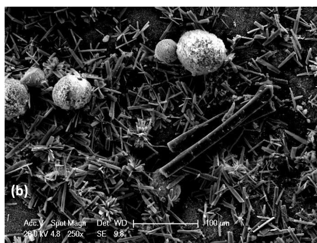
Figure V.7 Micrographie MEB de l'échantillon UD 2 (en présence d'extrait de noyaux de Phoenix dactylifera à 0,125 g/L), à différents agrandissements. (a) : cristallisation hétérogène de brushite agrégée d'aspect en oursin ou en macles et de granulations éparses d'apatite ; (b) : très forte abondance d'agrégats de cristaux de brushite en forme de baguette ou agrégés en forme de gerbe et d'apatite sous forme de granulations sphériques blanchâtres
