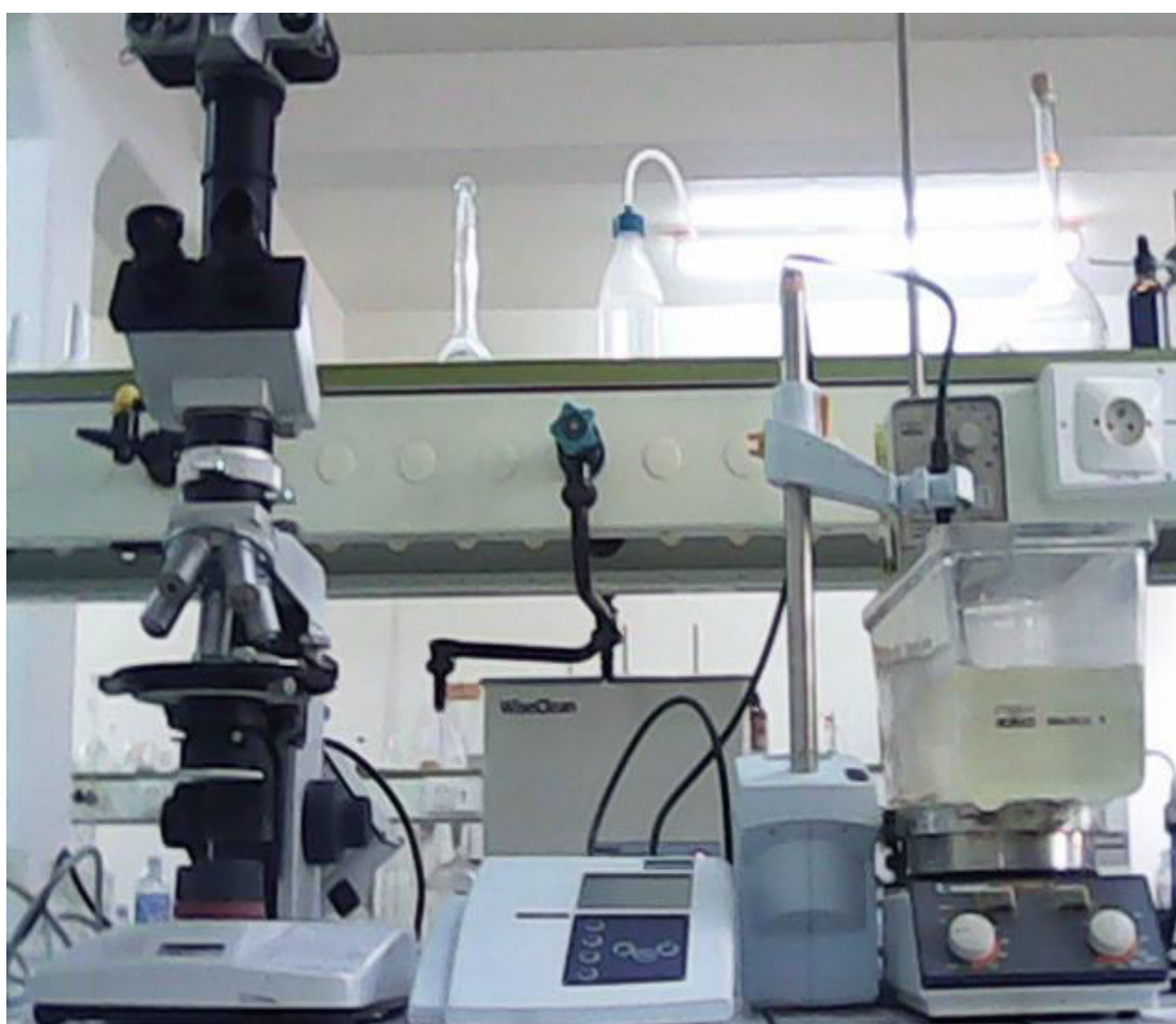
Figure IV.1 : Photo illustrant le montage expérimental utilisé pour le suivi conductimétrique de la cristallisation de la brushite en milieu aqueux.
