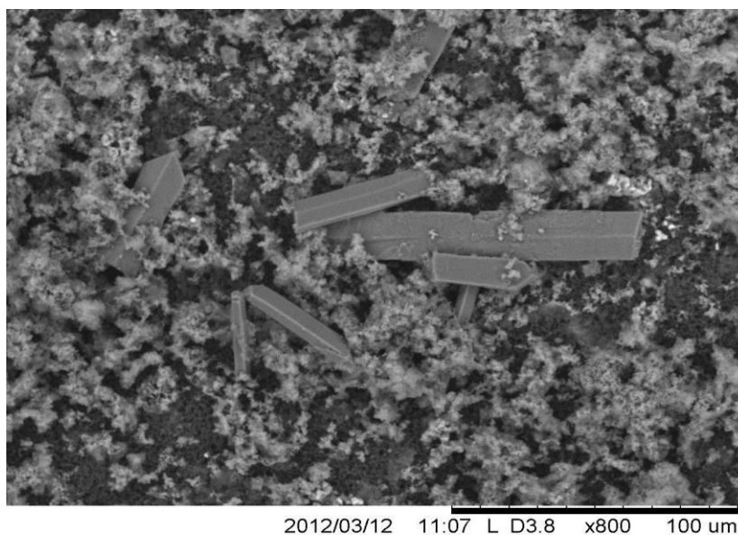
Figure V.82 Micrographie MEB de l'échantillon UH 1 (en présence d'extrait de Trigonella foenum à 0,0625 g/L, à l'agrandissement 800x.
