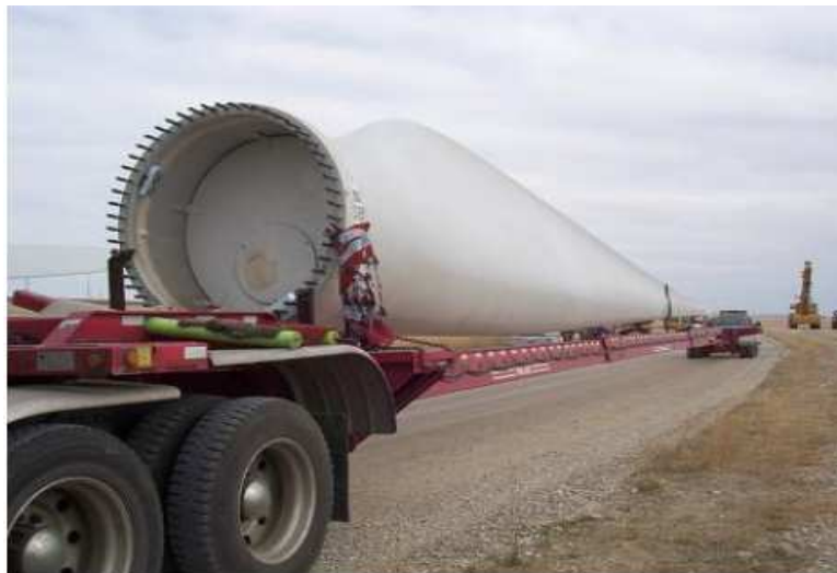
Fig.1.24 - Transport de pale d'une turbine éolienne de 1.5MW.
