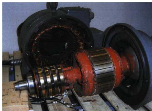
Fig.2.3 - Machine asynchrone à rotor bobiné (standard). [AGU10]
