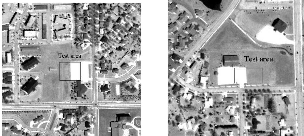
Figure 3.12 Exemples de parkings utilisés comme cible par la méthode bord de pages
