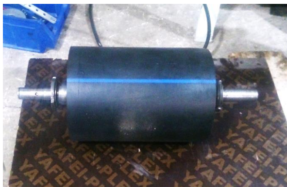
Figure III. 15 : Photographie tambour à aimants permanents logé dans un cylindre creux.
