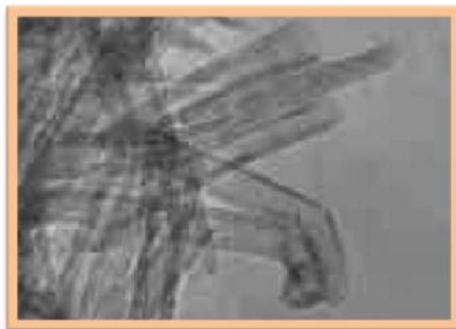
FigII.11 : Image par microscopie électronique à très haute résolution de nano-tube d'oxyde de titane (CNRS 2005)
