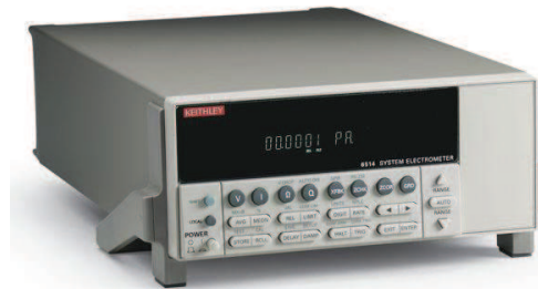
Figure II.10 : Electromètre numérique Keithley modèle 6514
