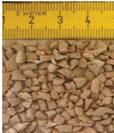
Figure II.2 : Echantillon des granules d'Acrylonitrile butadiène styrene (HIPS) utilisées
