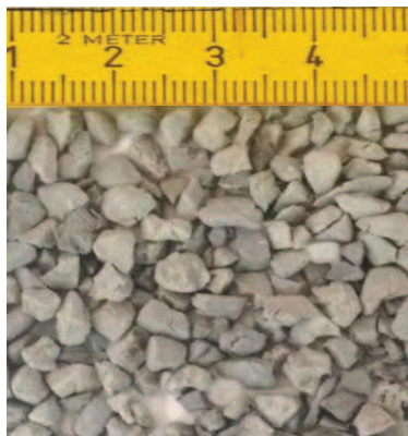
Figure II.6 : Echantillon des granules de Chlorure de polyvinyle (PVC) utilisées
