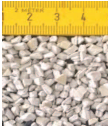
Figure II.3 : Echantillon des granules de High impact polystyrène (HIPS) utilisées
